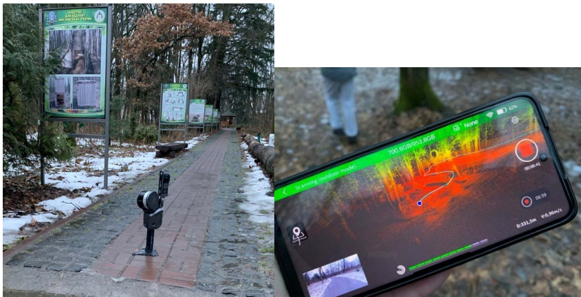
Рисунок 20. Знімання території ботанічного саду 3D сканером ALPHAGEO SLAM 100
