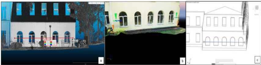
Рисунок 26. Зйомка відстаней між контрольними точками: а) лазерне сканування; в) лідар iPhone 13 Pro; с) зйомка тахеометром.
