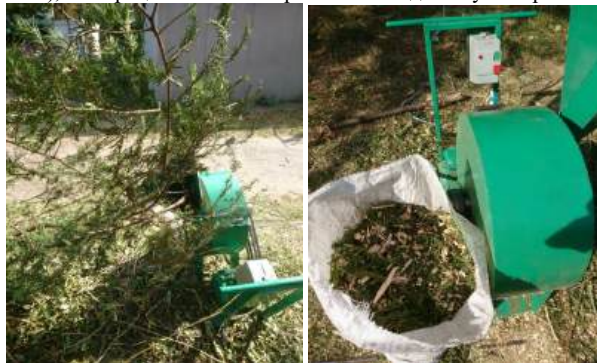
Рис. 2. Фото дослідження технологічних параметрів роботи подрібнювача деревної зелені для корму тварин
