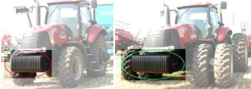
Рис. 3. Баластування тракторів CASE 310
