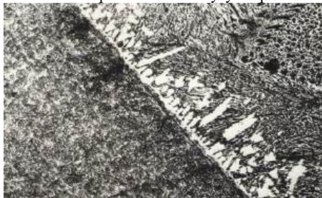
Рис. 3. Мікроструктура крапкового покриття x 320
