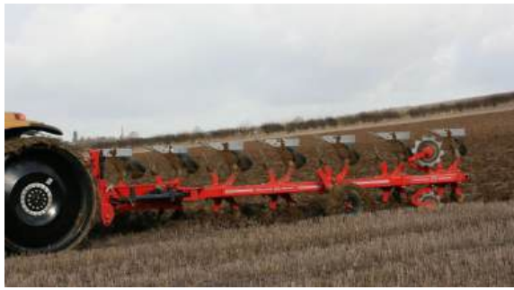
Рис. 2. Навісний семикорпусний оборотний плуг Gregoire Besson HRP-7
