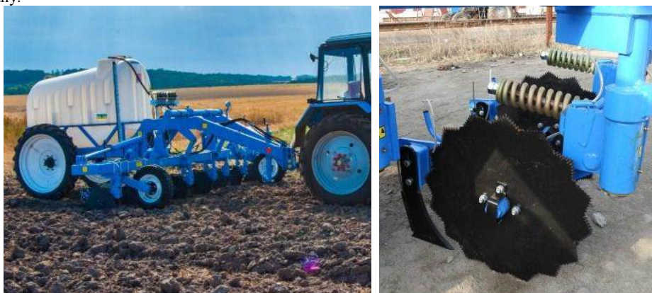
Рис. 2. Аплікатор ПЖУ-3000-6 для внесення рідких добрив
