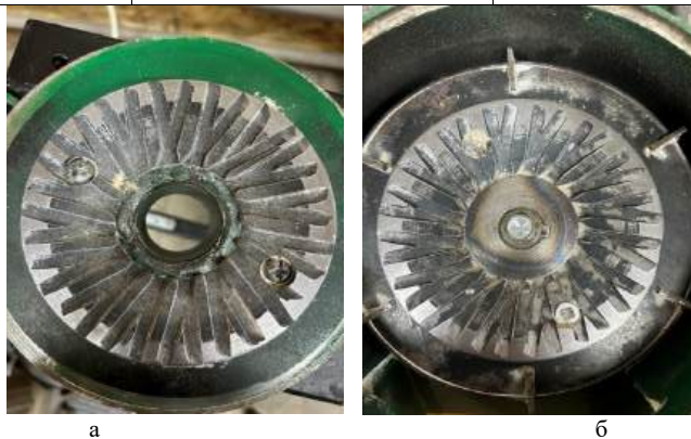
Рис. 2. Робочі органи дискового подрібнювача: а – нерухомий диск, б – рухомий диск
