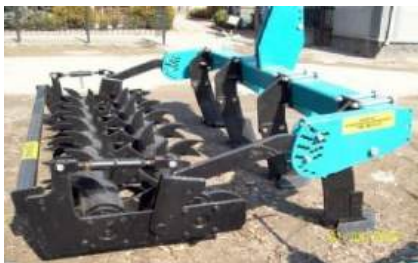
Рис. 2. Чизель ЧГ-40-02 з спеціальним котком виробництва Краснянський Агромаш (Україна).
