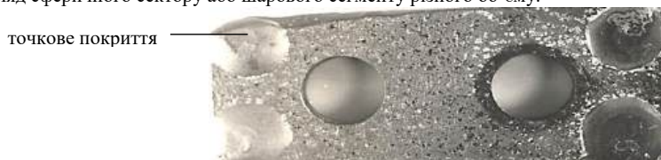
Рис. 1. Точкове покриття молотка кормодробарки. Наробіток на одну грань 500...600 тон продукту
